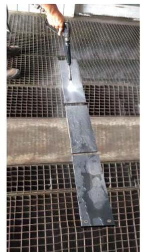
**Anwenderhinweis: Nur gereinigte Starkmagnet-Antirutschstreifen und saubere Gabelzinken garantieren hohe Rutschhemmung!**
