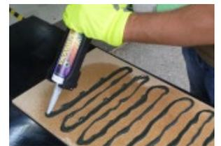
„BLACK-CAT“-Kraftkleber ist ein Ein-Komponenten-Klebstoff – ideal für Materialverbindungen mit unterschiedlichen Ausdehnungen dank einer **700%igen Bruchdehnung nach DIN 53504 – für dauerhafte Verklebung in Innen- und Außenbereichen** geeignet.
