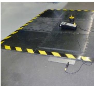
Bei ESD-Prüfungen mit verschiedenen Untergründen wurden elektrostatische Aufladwerte unter 40 Volt erreicht.
