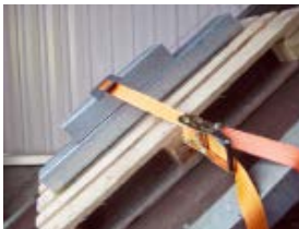
Neigungstest mit Antirutschpad
