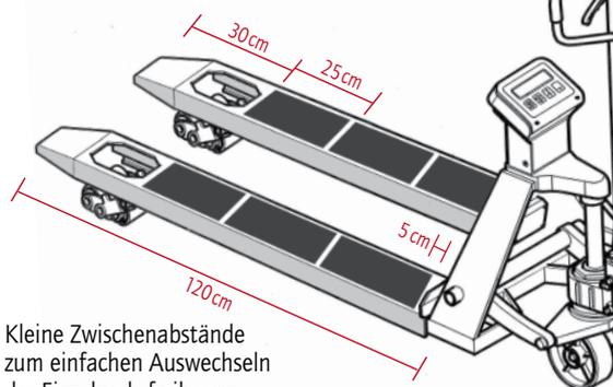
Kleine Zwischenabstände zum einfachen Auswechseln der Einzelpads freilassen
