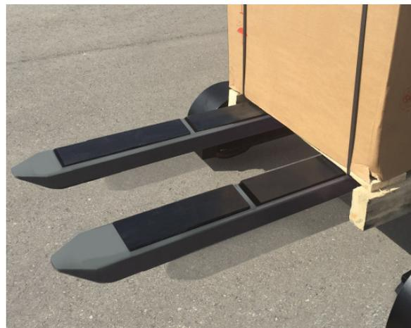
Auf beide 1,20-m-Staplerzinken aufkleben, dabei an der Vorderseite ca. 30 cm freilassen. Je drei „BLACK-CAT“-Panther Hightech Powerkleber Antirutschpads aufkleben, hinten ca. 5 cm freilassen
