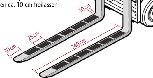
Zum Lösen der HPP-Antirutschpads ist ein Flachscherer beige-packt. Angeklebte HPP-Antirutschpads müssen mit dem Flachscherer angehoben und mit Schwerkraft flach abgezogen werden, um das Antirutschpad abzulösen. Danach Reinigung und neuen Pad aufkleben.
